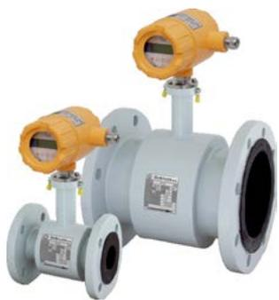
Электромагнитные расходомеры серии FLONET FH 10XX предназначены для непрерывного измерения объема протекающих по трубопроводу электропроводных жидкостей, а также преобразования его в выходной сигнал (импульсный, частотный, аналоговый 4...20 мА + HART).
