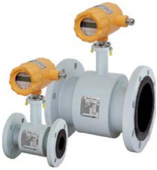
Электромагнитные расходомеры серии FLONET FH 10XX предназначены для непрерывного измерения объема протекающих по трубопроводу электропроводных жидкостей, а также преобразования его в выходной сигнал (импульсный, частотный, аналоговый 4...20 мА + HART).
