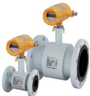
Электромагнитные расходомеры серии FLONET FS 10XX предназначены для непрерывного измерения объема протекающих по трубопроводу электропроводных жидкостей, содержащих в своем составе высокообразивные частицы и преобразования его в вы-ходной сигнал (импульсный, частотный, аналоговый 4...20 мА + HART).
