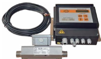
Ультразвуковой расходомер с сетевым питанием  $\sim(100...230)$  В SONOELIS SE 409X предназначен для непрерывного измерения расхода токопроводящих, непроводящих и агрессивных жидкостей, а также преобразования его в выходной сигнал (импульсный, частотный, аналоговый 0/4...20 мА).
