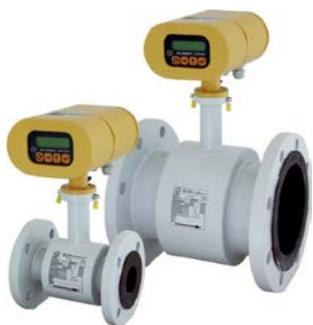
Электромагнитные расходомеры серии FLONET FN 20XX.1 предназначены для непрерывного измерения объема протекающих по трубопроводу электропроводных жидкостей, а также преобразования его в выходной сигнал (импульсный, частотный, аналоговый 4...20 мА).
