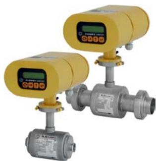
Электромагнитные расходомеры серии FLONET FN 10XX.1 предназначены для непрерывного измерения объема протекающих по трубопроводу электропроводных жидкостей, а также преобразование его в выходной сигнал (импульсный, частотный, аналоговый 4...20 мА).
